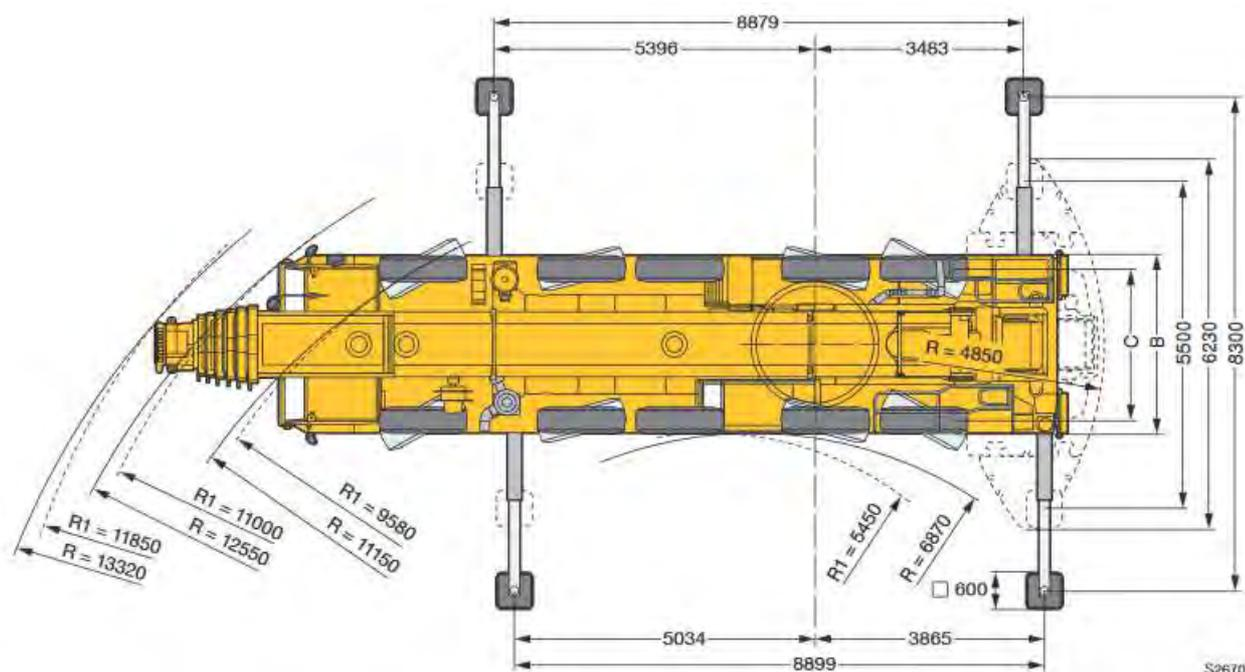
R<sub>1</sub> = Allradlenkung - All-wheel steering - Direction toutes roues - Tutti gli assi sterzanti - Dirección en todos los ejes - Поворот всеми колесами
